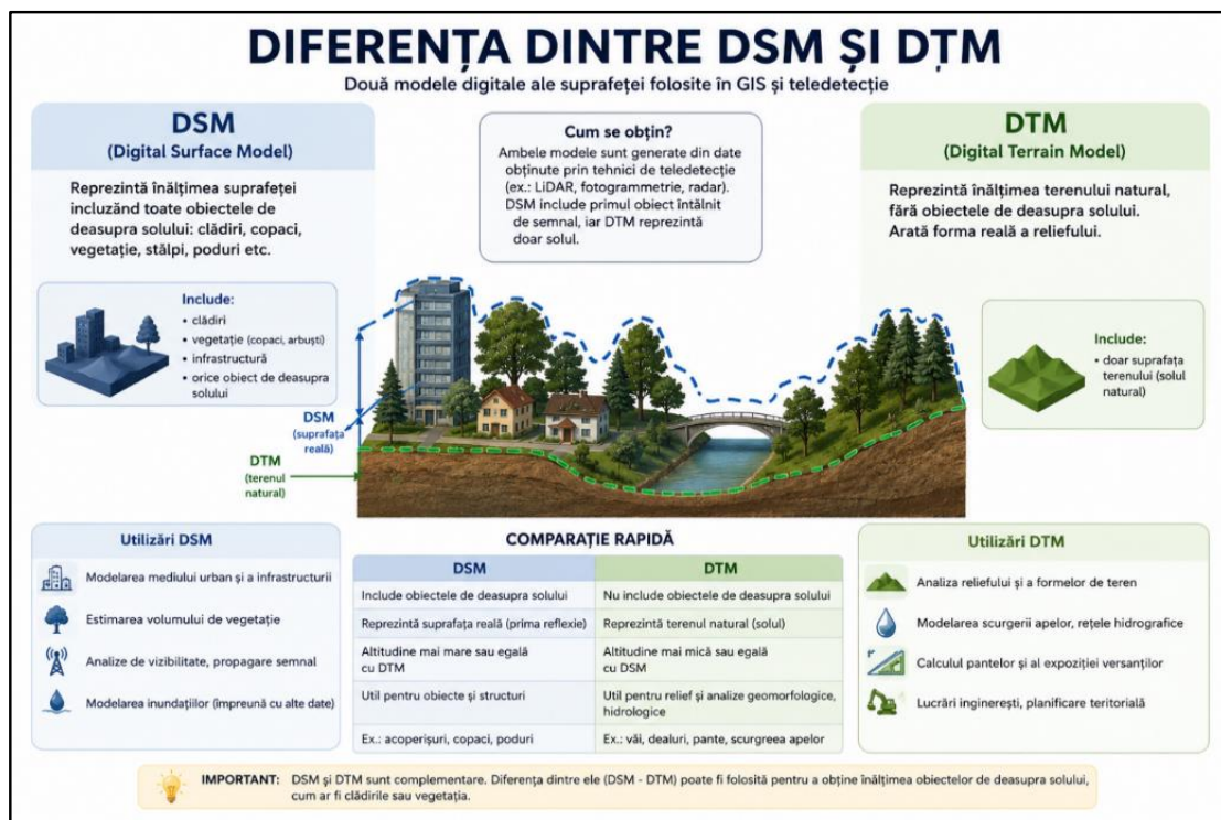
Figura 2.13. Diferența dintre DTM și DSM
