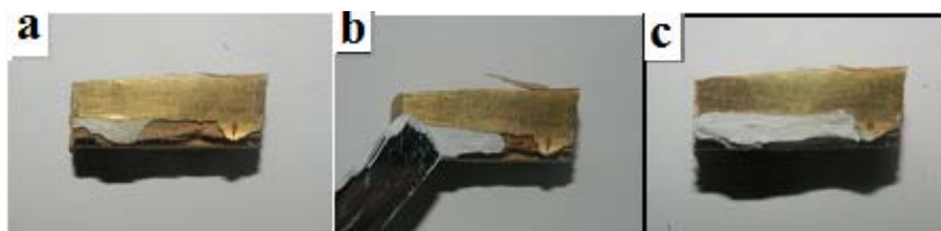
Fig. 13. Proba nr. 2: a – dupa pensularea liantului acrilic; b – in timpul aplicarii grundului Acrylic Primer; c – la finalul completarii lacunei cu Acrylic Primer.
