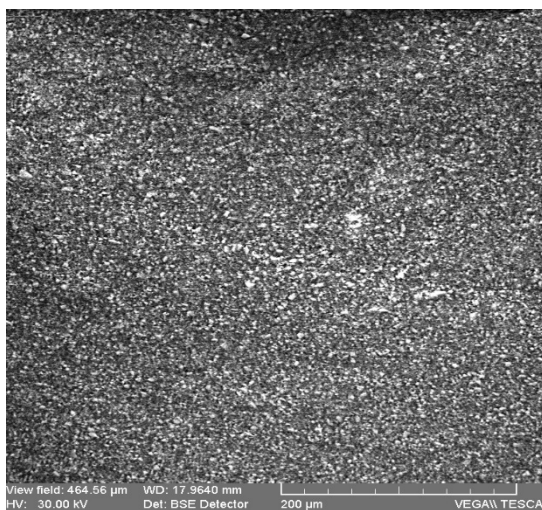
Fig. 14. Microfotografie SEM-EDX a grundului Acrylic Primer (500xbse).
